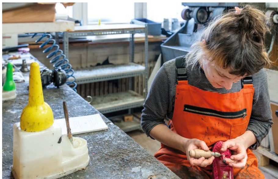
^ Cleo Krebs répare le talon de la chaussure en soulevant d'abord délicatement le cuir.
